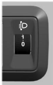
Gire el control según la carga del vehículo para evitar distraer a otros conductores cuando las ópticas delanteras están encendidas.
