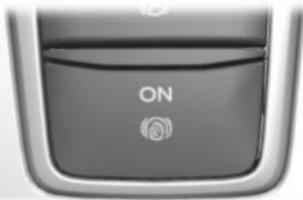
Presione el botón en la consola para acceder a la función de espera automática en la pantalla táctil.
