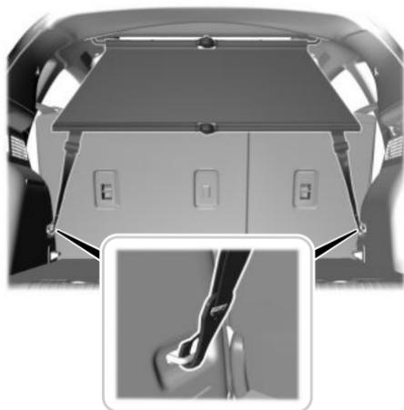
2. Sujete la red a los puntos de anclaje para equipaje.
