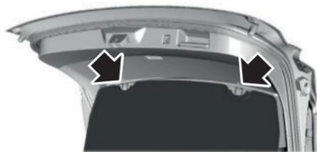
3. Inserte los sujetadores en el panel de revestimiento del portalón trasero.
