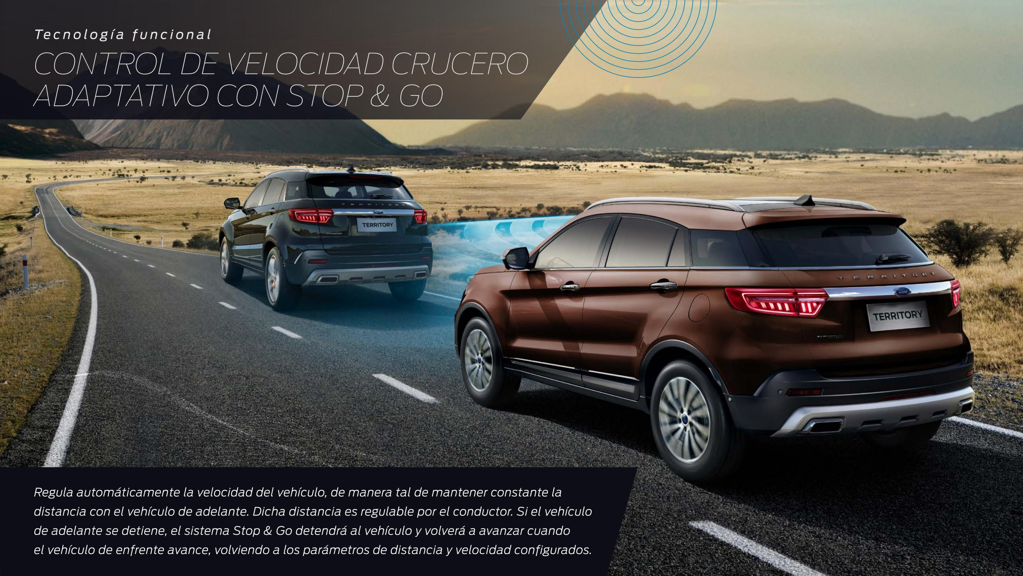
*Regula automáticamente la velocidad del vehículo, de manera tal de mantener constante la distancia con el vehículo de adelante. Dicha distancia es regulable por el conductor. Si el vehículo de adelante se detiene, el sistema Stop & Go detendrá al vehículo y volverá a avanzar cuando el vehículo de enfrente avance, volviendo a los parámetros de distancia y velocidad configurados.*
