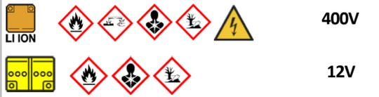
⚠ Si el refrigerante se escapa del sistema de enfriamiento de la batería, existe riesgo de una reacción térmica en la batería de alta tensión. ¡Monitorear la temperatura de la batería de alta tensión!
